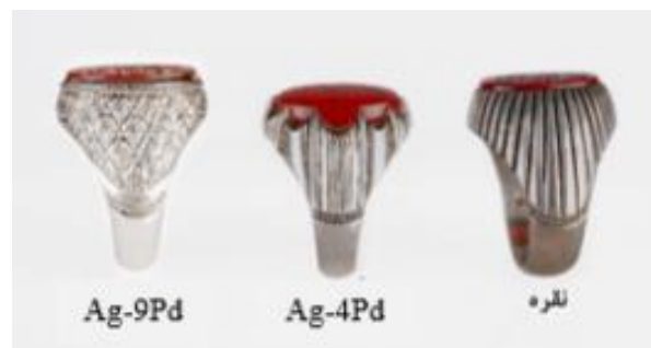
شکل ۸- تصویر درخشش انگشتی‌های تولید شده با آلیاژهای مختلف پس از دو سال کارکرد.
